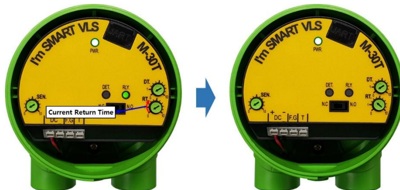
[Current Return Time 설정에 따른 동작 상태]
