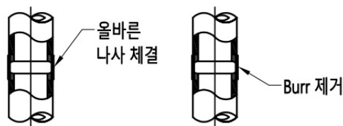
[그림10-1] 적절한 Pipe 나사 연결
