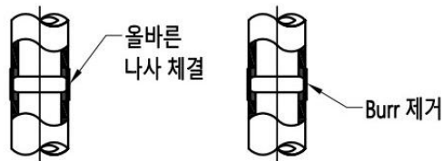
[그림3-1] 적절한 Pipe 나사 연결
