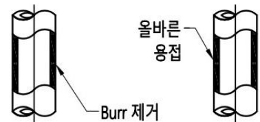
[그림3-2] 적절한 Pipe 용접 연결
