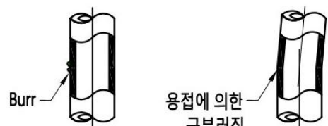
[그림3-4] 부적절한 Pipe 용접 연결
