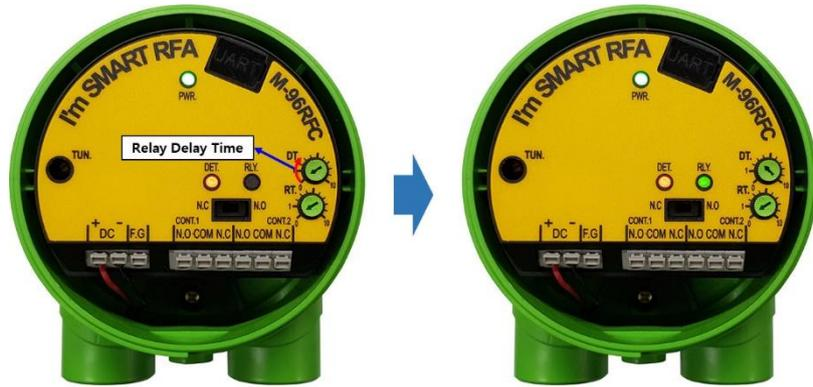
[Relay Delay Time 설정에 따른 동작 상태]
